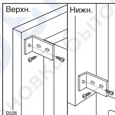
Прикрепите прибор к столешнице или к боковым панелям с помощью фиксирующих скоб (Е). Затем между холодильником и прилегающими панелями мебели проложите ленту уплотнителя.
