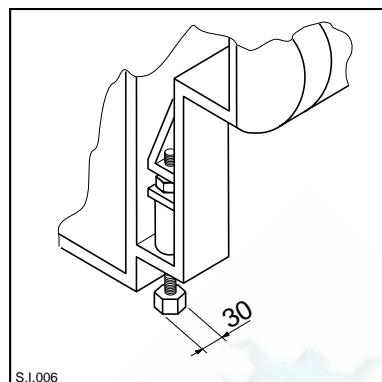
Установить направляющие (H) на внутреннюю поверхность дверцы шкафа, как показано на рисунке, и отметить положение наружных отверстий.
